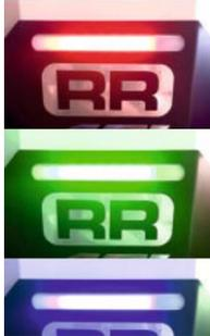
Der hochintensive RGB-LED-Streifen auf der Frontabdeckung ermöglicht dem Bediener, sich während der Ausführung des automatischen Vorgangs anderen Aufgaben zu widmen. Anhand der Farbe kann er den Status der Maschine verstehen:
