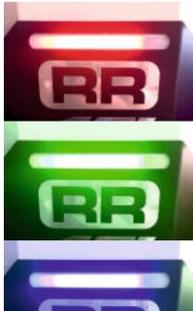
Der hochintensive RGB-LED-Streifen auf der Frontabdeckung ermöglicht dem Bediener, sich während der Ausführung des automatischen Vorgangs anderen Aufgaben zu widmen. Anhand der Farbe kann er den Status der Maschine verstehen:
