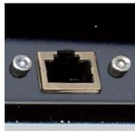
TopAuto-Klimaservicestationen können mit einem Ethernet-Modul und einem WLAN-Modul ausgestattet werden. Zusätzlich zur Fernsteuerung der Station über ein Smartphone oder einen PC können Sie durch die Erstellung einer Verbindung zum Netzwerk alle Daten auf einem PC speichern und über unseren *Customer Support* technische Fernunterstützung erhalten.
